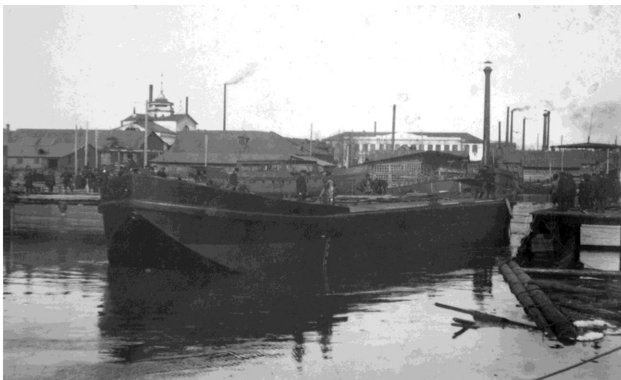
Рис. 4. Готовый корпус баржи. Фото 1913–17 гг. (АВЗ. Альбом «Судостроение». Фото № 30). Это однозначно не баржа, а грунтоотвозная шаланда, что видно по обводам корпуса: шаланды имели характерный скос носа. По-видимому, фото сделано одновременно с фото № 28 (там эта шаланда на заднем плане справа). Исходя из этого фото можно датировать 1913 г., а шаланду – одной из шаланд каравана «Шуляченко».
